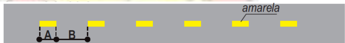
Detalhe Faixa Seccionada.
